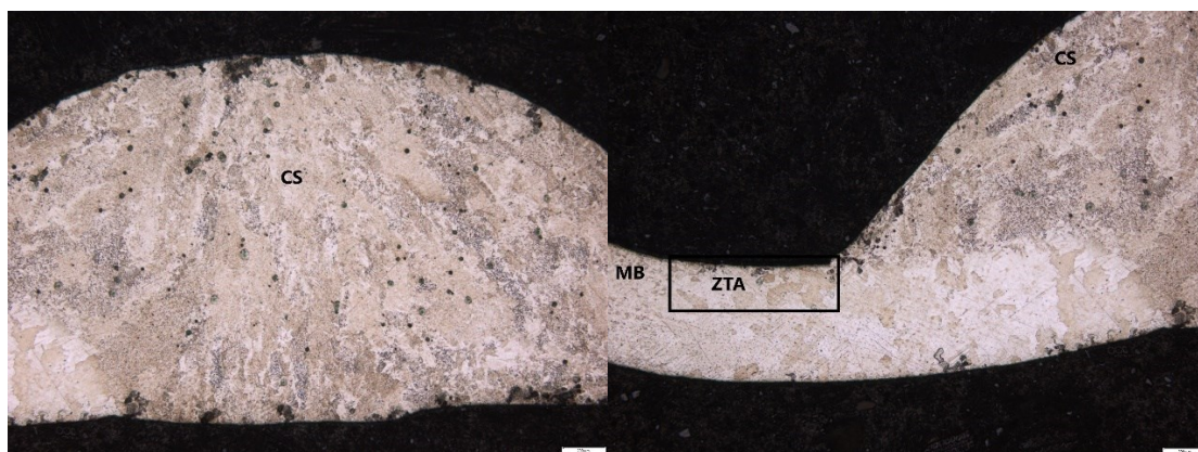
Figura 10 - Micrografia na escala de 200 \mu m da amostra MAG C (a) Cordão de solda (b) Metal base e ZTA
