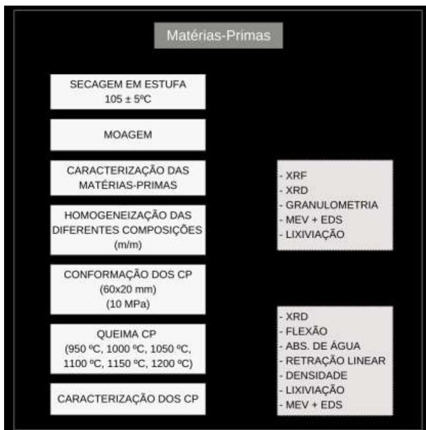
Figura 17 - Fluxograma do processo de manufatura dos cps e dos ensaios.
