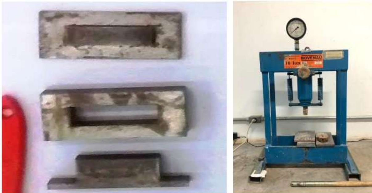
Figura 19- Conjunto molde metálico e prensa hidráulica
