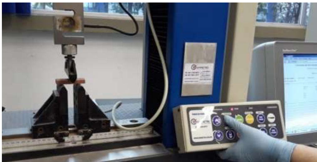
Figura 22 - Determinação do módulo de resistência à flexão após a queima
