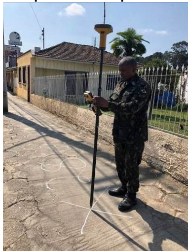
Figura 19 – Imagem de implantação de pontos de apoio aerofotogramétricos no terreno com receptor GNSS Topcon GR-3
