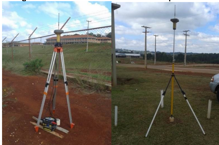
Figura 17 – Imagem do rastreamento dos Marcos com o receptor GNSS Topcon GR-3
