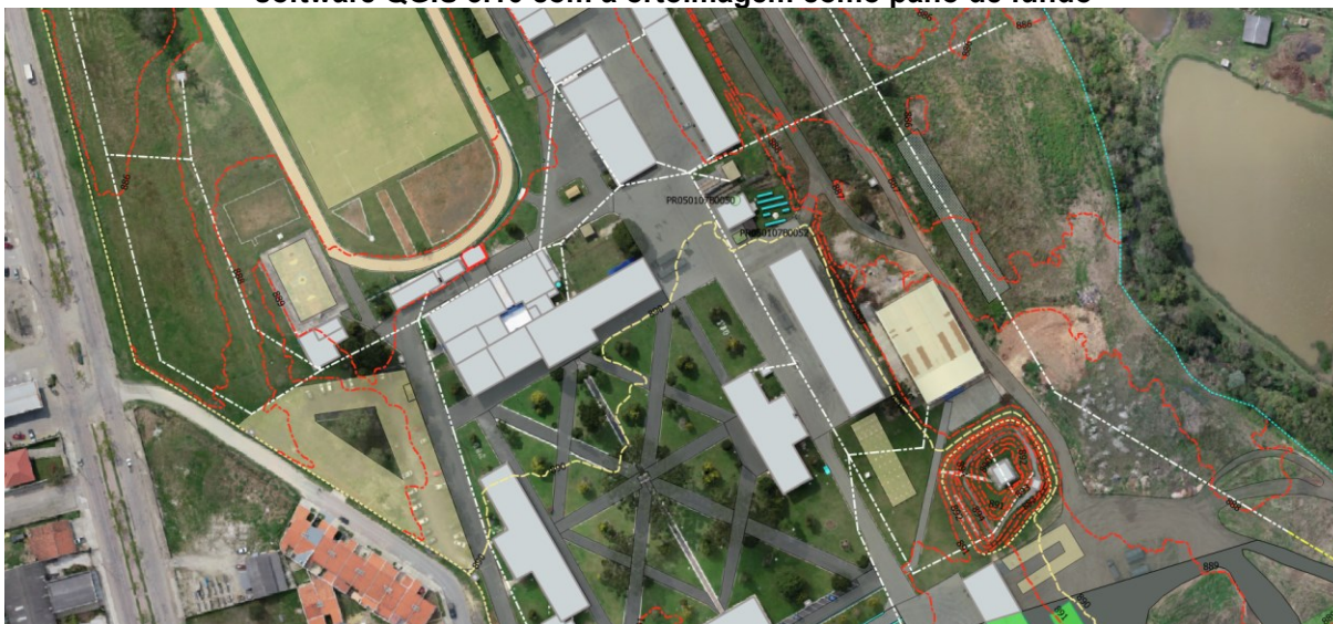
Figura 23 – Extrato da área do experimento 1 tendo suas informações atualizadas por meio do software QGIS 3.10 com a ortoimagem como pano de fundo
