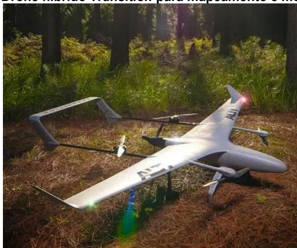
Figura 12 – Drone híbrido Transition para mapeamento e monitoramento
