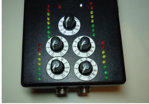
Figura 19 – Painel do instrumento com controle de sensibilidade de cada sensor. Fonte: própria.
