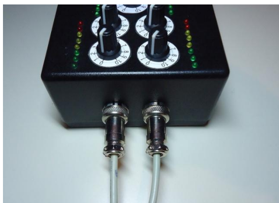
Figura 21 – Conectores para ligação das palmilhas ao Baropodômetro. Fonte: própria.
