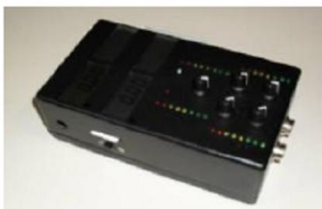
Figura 11 – Disposição das colunas de 8 leds no aparelho [7].
