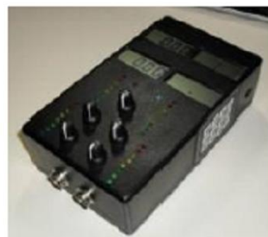
Figura 10 – Equipamento montado e seus respectivos componentes de interface com o usuário (Displays, leds, botões de controle e teclado) [7].
