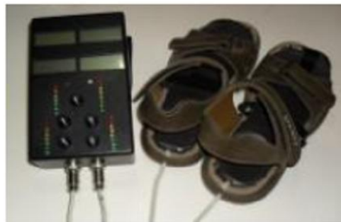
Figura 16 – Conexão das palmilhas através de fios na unidade principal [7].
