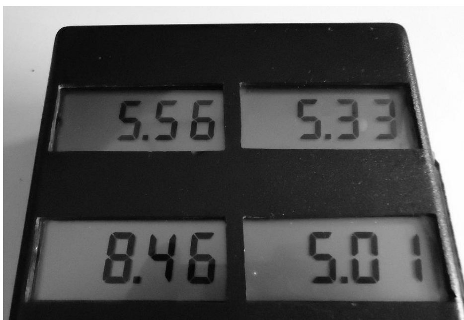
Figura 27 – Disposição dos quatro displays de 3 e \frac{1}{2} dígitos no painel do equipamento. Fonte: própria.
