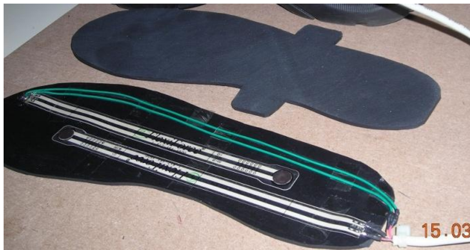
Figura 13 – Sensores montados sobre a parte inferior da palmilha. Fonte: própria.
