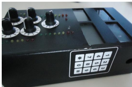
Figura 31 – Disposição teclado na lateral direita do Baropodômetro. Fonte: própria.
