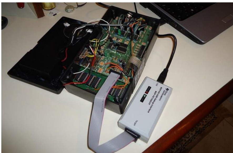
Figura 33 – Ligação do FETMSP430® para programação e depuração do FW do equipamento. Fonte: própria.
