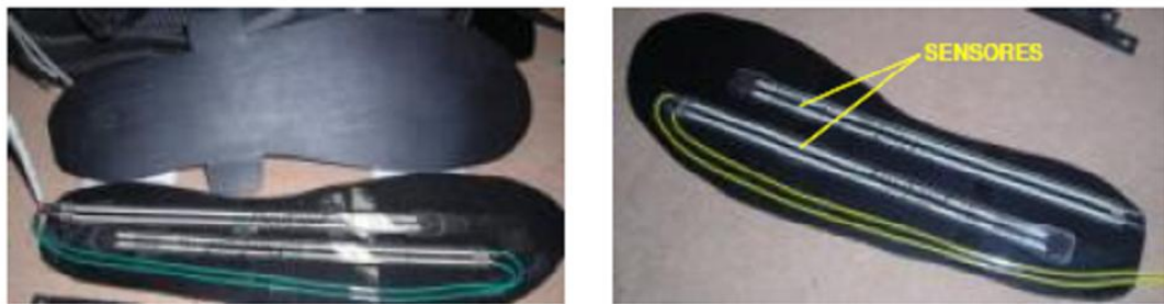
Figura 15 – palmilhas confeccionadas com os sensores de pressão [7].
