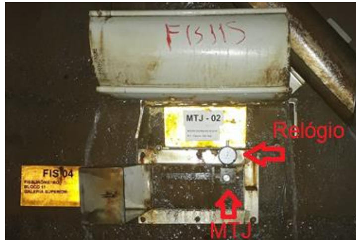
Figura 15 - Relógio comparador acoplado ao MTJ
