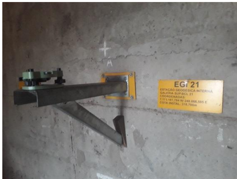
Figura 18 - Dispositivo de centragem de força fixo na parede
