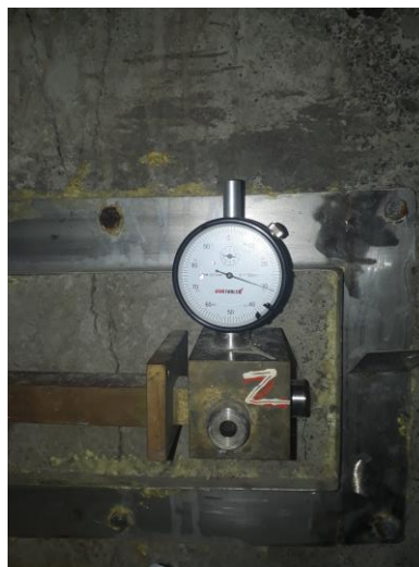
Figura 6 - Relógio comparador aferindo deslocamento no MTJ
