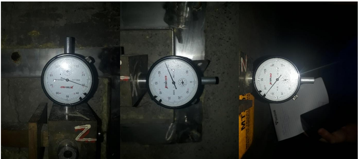
Figura 16 - Relógio comparador efetuando medições nas 3 extremidades do MTJ
