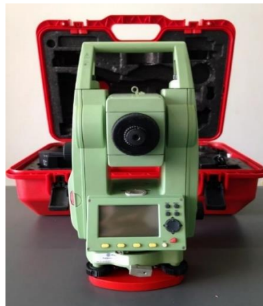
Figura 13 - Estação Total LEICA TC 407
