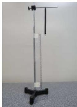
2. Medir a massa do conjunto (60 g + gancho suporte).  $m_{\text{conjunto}} = \text{_____}$  kg. Utilizar todas as casas após a vírgula. Anotar o valor obtido no Quadro 4 na coluna (massa oscilante pendurada).
