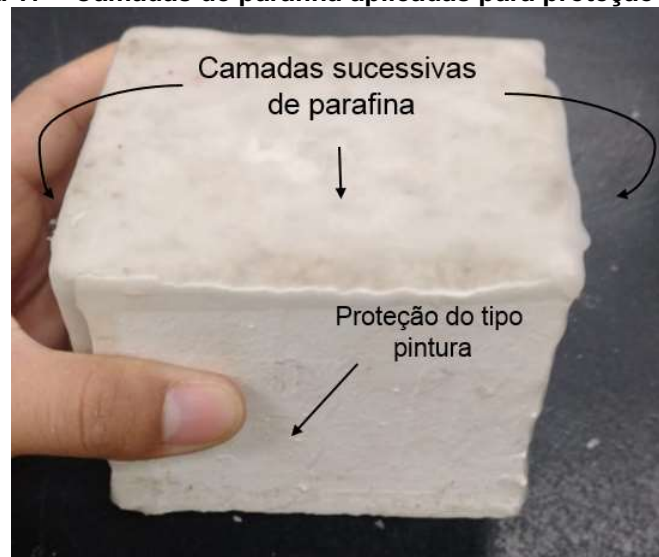
Figura 17 – Camadas de parafina aplicadas para proteção dos CP
