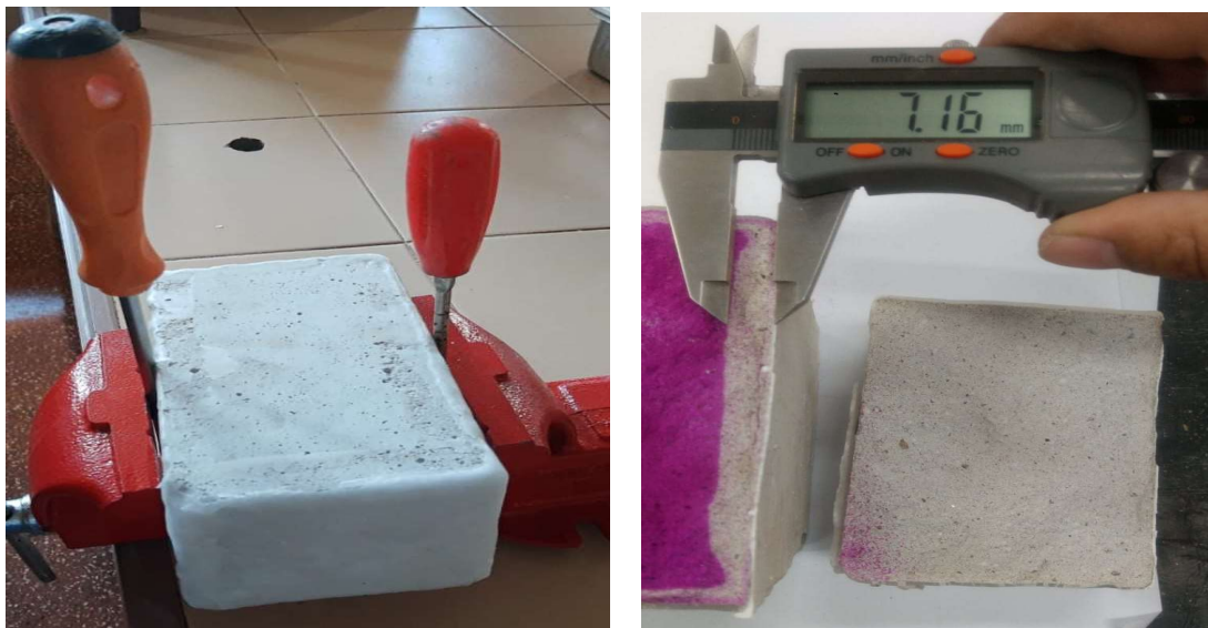
Figura 22 – a) Processo de fratura de CP b) Medição da profundidade carbonatada após aspensão de fenolftaleína
