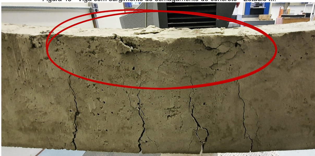
Figura 43 - Viga com surgimento de esmagamento do concreto - Estádio III.
