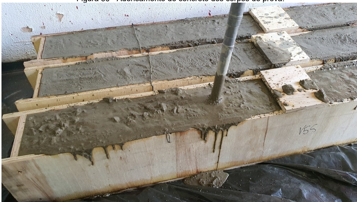
Figura 36 - Adensamento do concreto dos corpos de prova.
