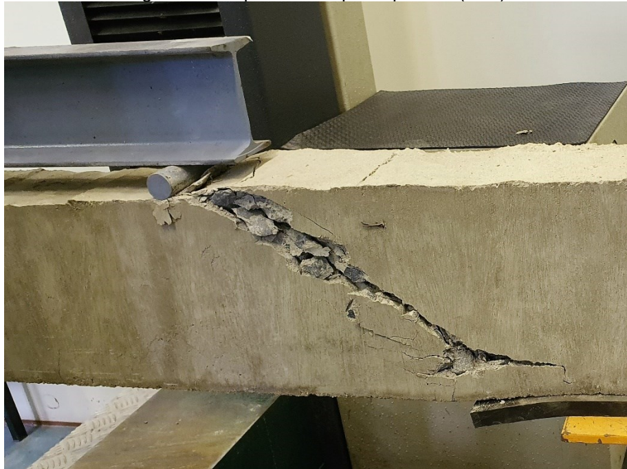
Figura 48 - Ruptura do corpo de prova 5 (V5S).
