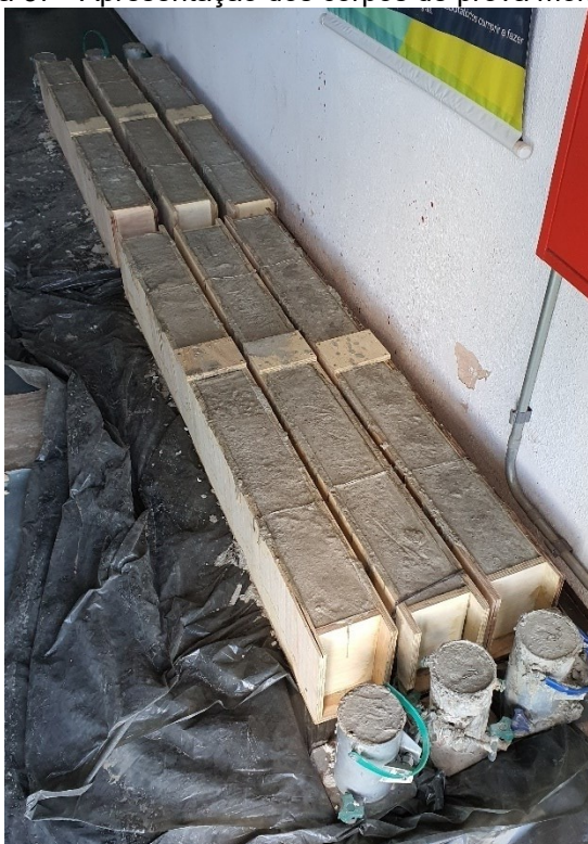
Figura 37 - Apresentação dos corpos de prova moldados.
