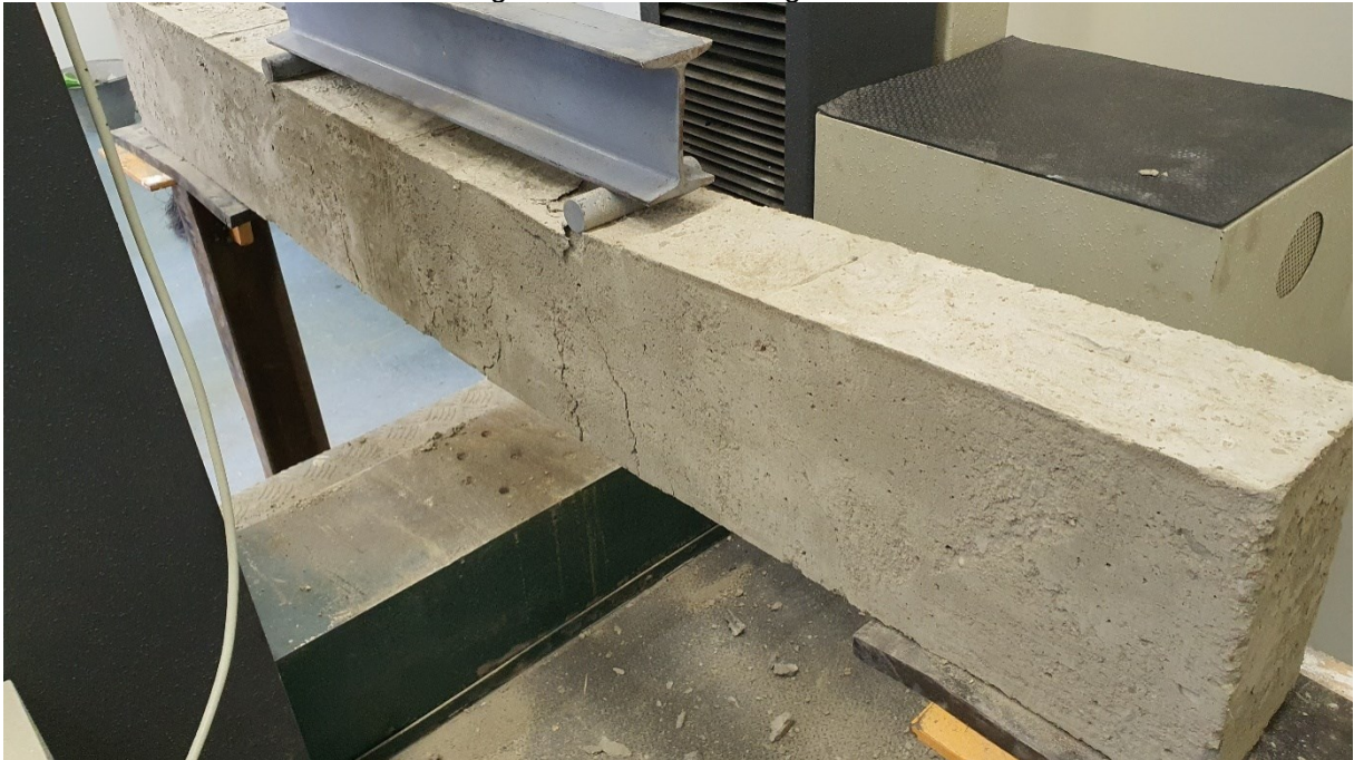
Figura 46 - Ensaio da Viga V1A.
