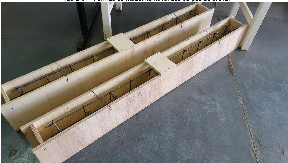
Figura 34 - Formas de madeirite naval dos corpos de prova.
