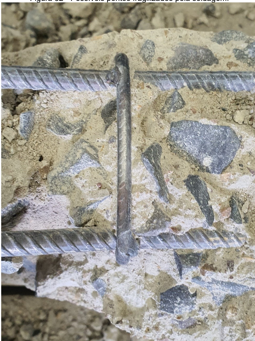
Figura 52 - Possíveis pontos fragilizados pela soldagem.
