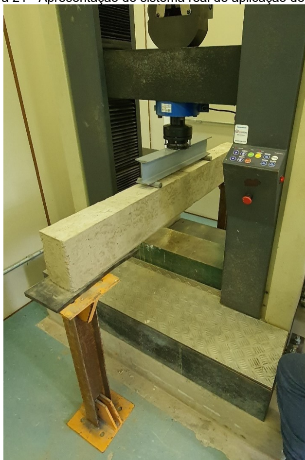
Figura 21 - Apresentação do sistema real de aplicação de força.
