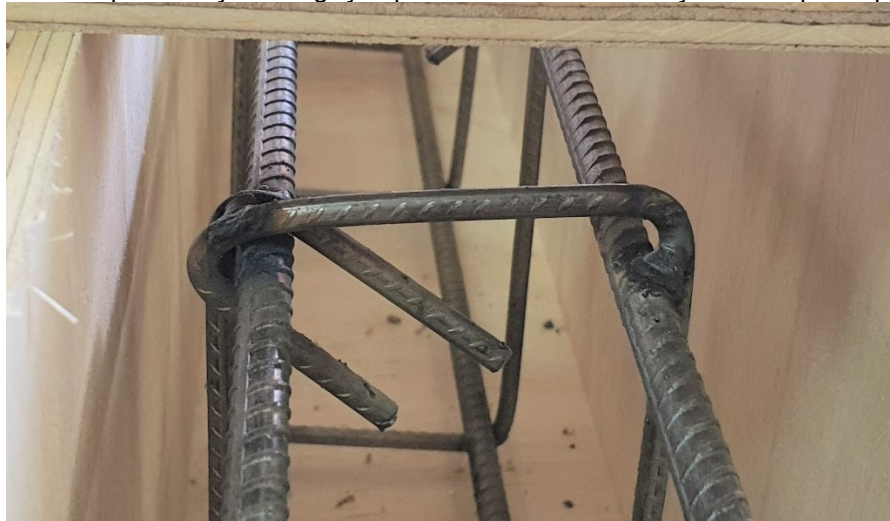
Figura 33 - Apresentação da ligação por solda em uma armação do corpo de prova.
