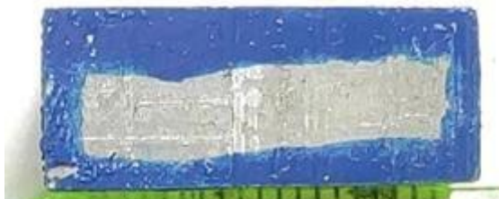
Figura 11 - Corpo de prova revestido para limitar a área da face exposta em área
