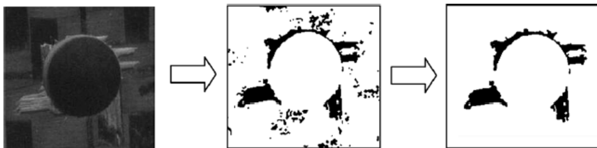
Figura 20 - Operação de processamento da imagem para determinar a área danificada: (a) imagem digital; (b) processamento inicial; (c) imagem final
