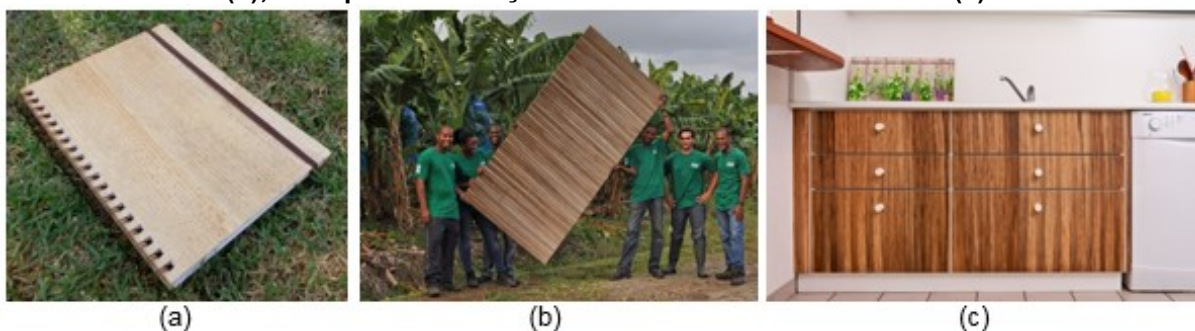
Figura 11 - Capa de caderno com fibras de bananeira (a); revestimento com fibras de bananeira (b); exemplo de utilização do revestimento em mobiliário (c)
