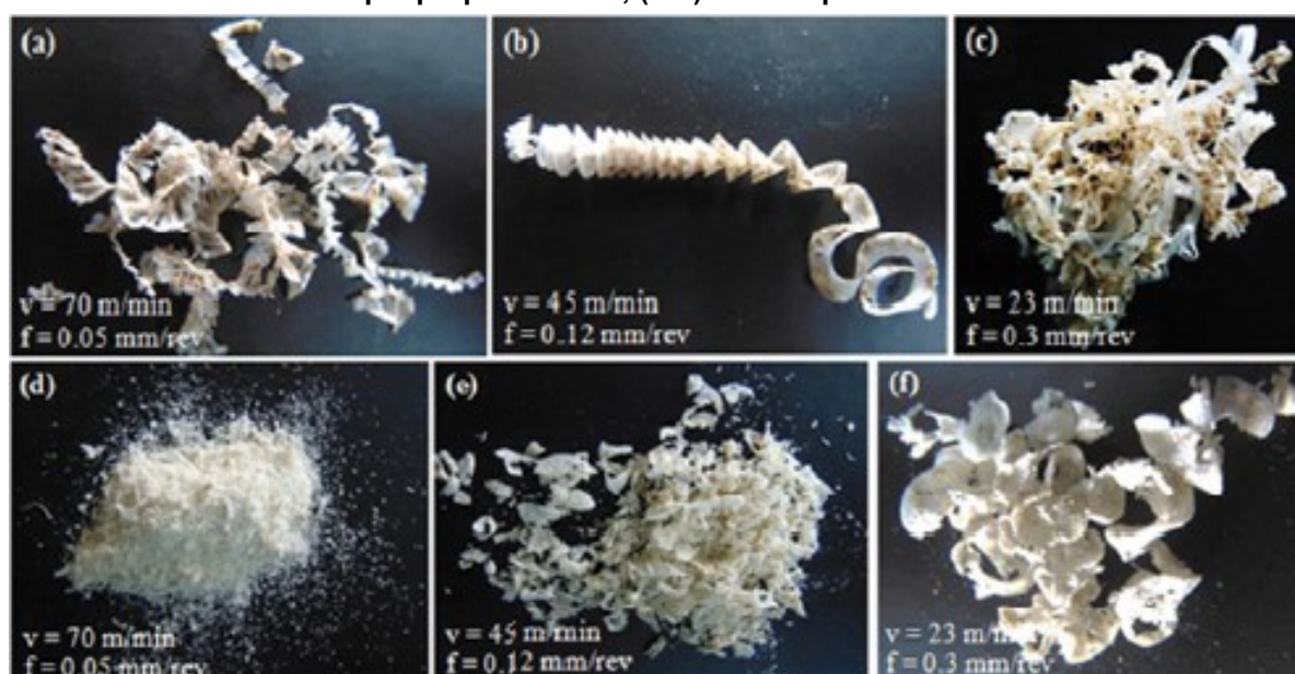
Figura 25 – Cavacos gerados na furação de compósito com fibras vegetais: (a-c) matriz polipropileno/sisal; (d-e) matriz epóxi/sisal
