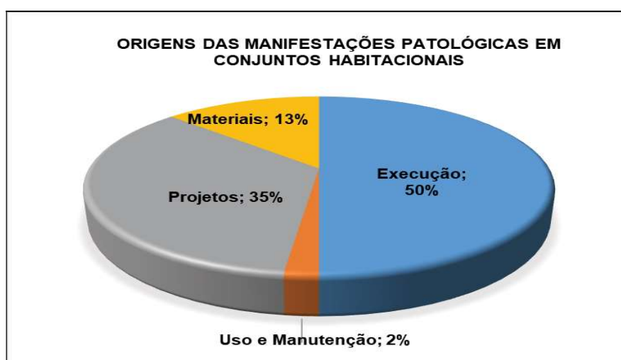
Gráfico 2 – Maior incidência de manifestações patológicas na fase de execução do processo construtivo segundo Fiess et al (2004). Fonte: FIESS et al. (2004)
