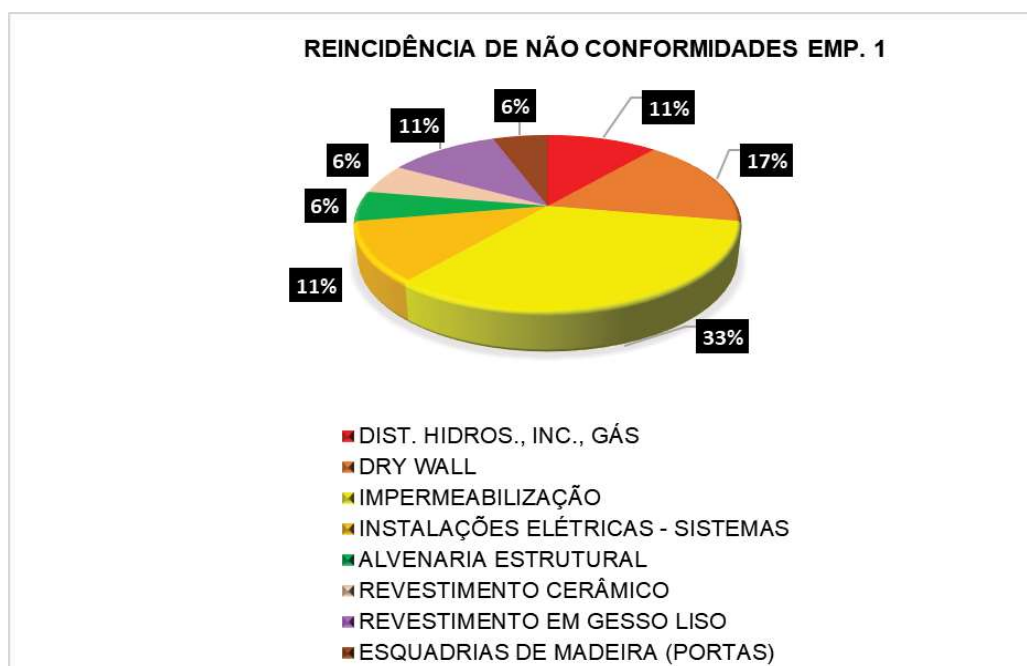
Gráfico 22 - Índices de reincidências de não conformidades na execução dos serviços do empreendimento 1 Fonte: Autoria Própria.
