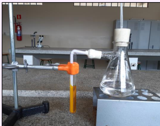
Figura 10: Esquema de montagem para o experimento princípio químico do bafômetro (Fonte: Arquivos da pesquisa)
