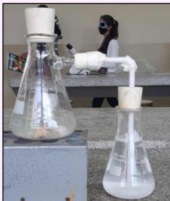
Figura 7: Esquema para se observar a formação de \text{CaCO}_3(\text{s}) ( Fonte: Arquivos da pesquisa)
