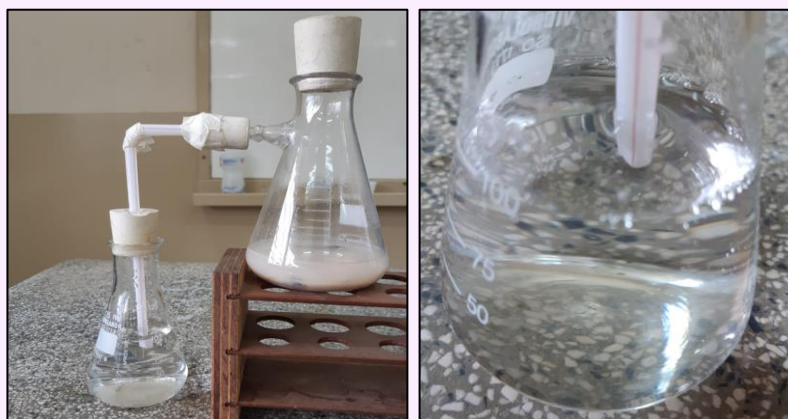
Figura 7: Esquema para se observar a formação de bolhas ( Fonte: Arquivos da pesquisa)
