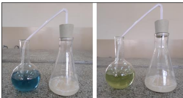
Figura 61 – Experimento fermentação alcoólica com solução indicadora azul de bromotimol (Fonte: Arquivos da pesquisa).
