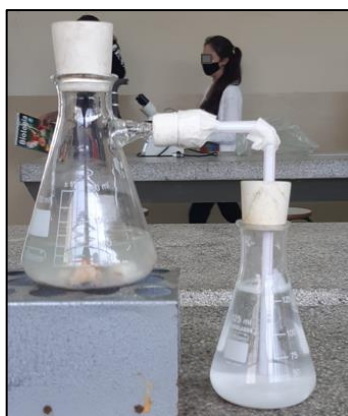
Figura 60 – Esquema para se observar a formação de \text{CaCO}_{3(s)} ( Fonte: Arquivos da pesquisa ).
