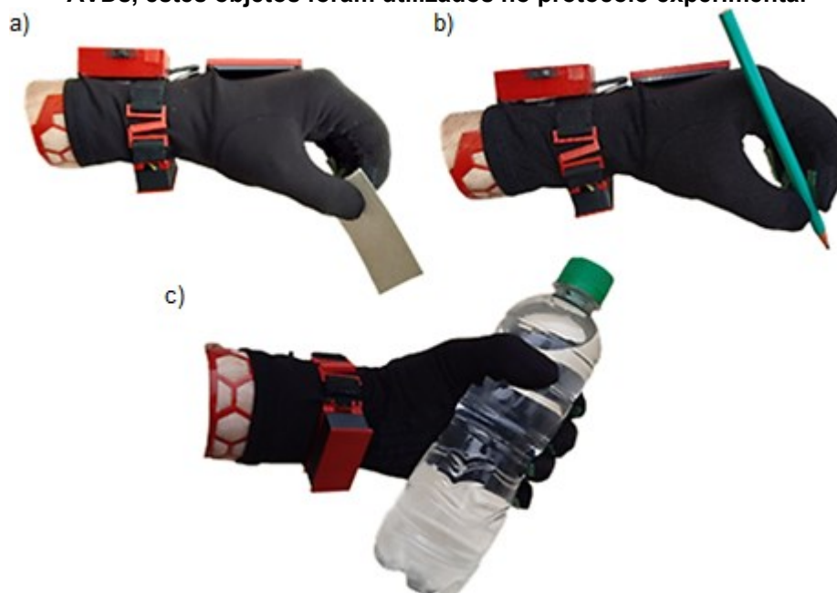
Figura 64 – Prensões pinça e cilíndrica executadas pela órtese em objetos utilizados em AVDs, estes objetos foram utilizados no protocolo experimental
