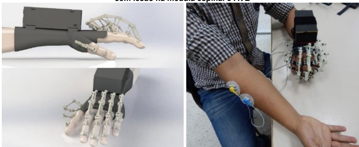
Figura 8 – Órtese mioelétrica desenvolvida por Abdallah, Bouteraa e Rekik (2017) para pessoas com lesão na medula espinal e AVE
