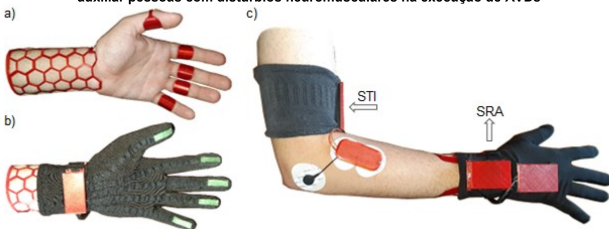
Figura 63 – Voluntário vestindo a órtese mioelétrica user-tuned proposta neste estudo para auxiliar pessoas com distúrbios neuromusculares na execução de AVDs
