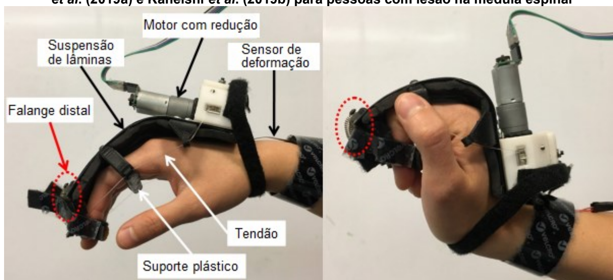
Figura 6 – SSAM, órtese mioelétrica semiflexível de tamanho único desenvolvida por Kaneishi et al. (2019a) e Kaneishi et al. (2019b) para pessoas com lesão na medula espinal
