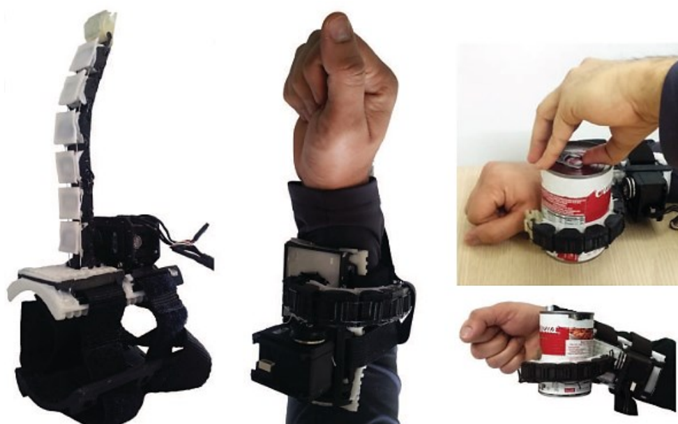
Figura 9 – Dedo supranumerário mioelétrico para pessoas com AVE crônico e paralisia unilateral
