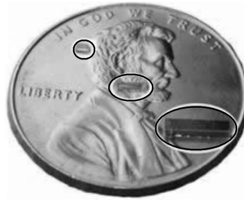
Figura 5: Sensores biotelemétricos passivos para monitoração da pressão arterial, produzidos pela empresa ISSYS. Comparação entre as dimensões de três sensores e uma moeda de um centavo de dólar.
