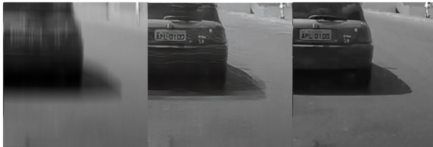
(c) Imagem borrada com kernel 33 e ângulo 90°. Imagem restaurada, SSIM=0,83 e PSNR = 25,8. Imagem Original
