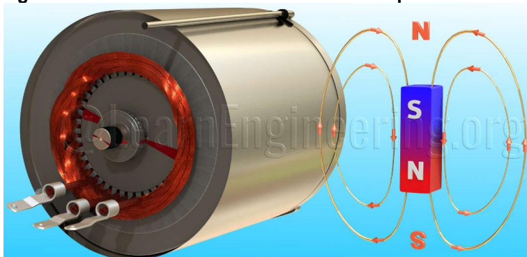
Figura 19 – Funcionamento do motor de ímã permanente
