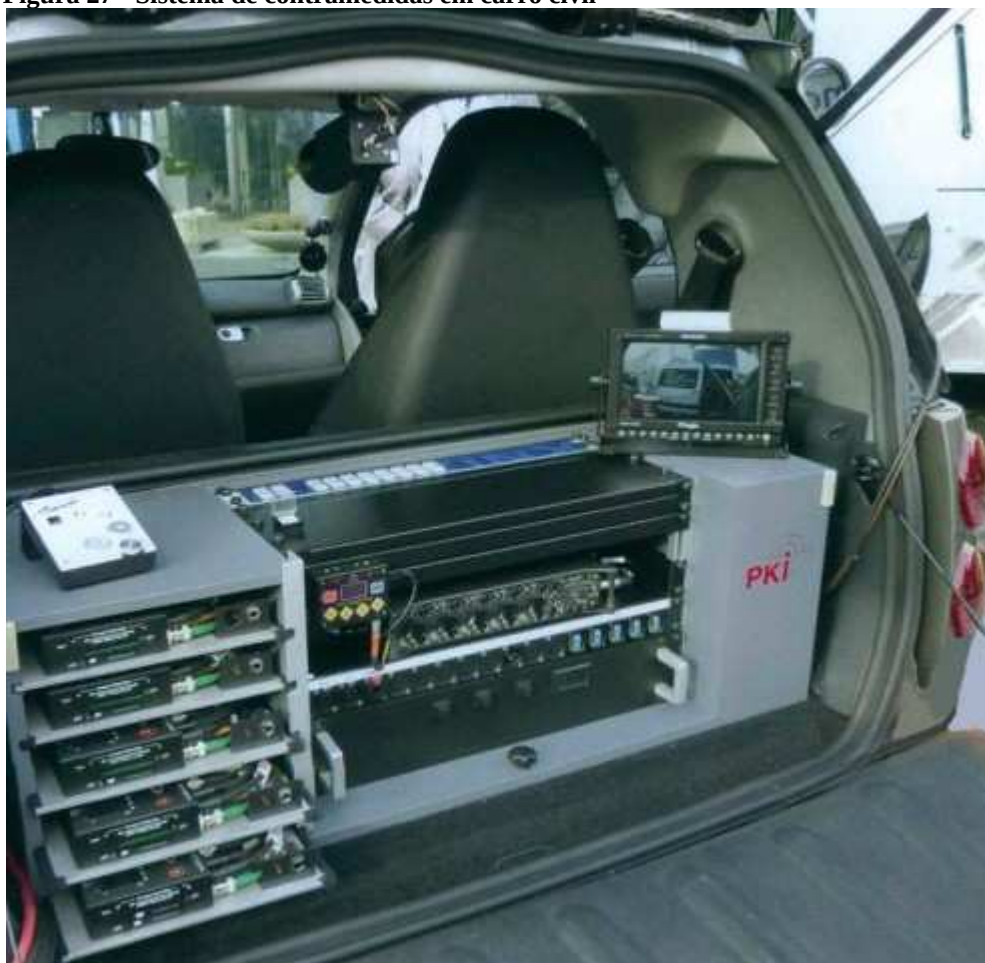
Figura 27 - Sistema de contramedidas em carro civil
