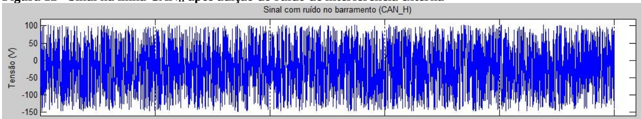
Figura 12 - Sinal na linha CAN H após adição do ruído de interferência externa
