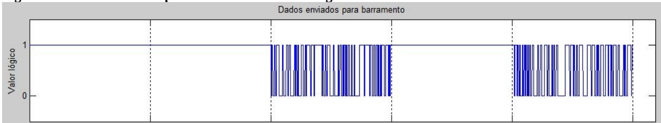
Figura 10 - Dados enviados para módulo de saída analógica
