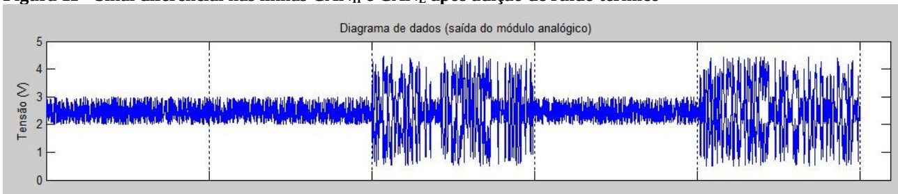
Figura 11 - Sinal diferencial nas linhas CAN H e CAN L após adição de ruído térmico
