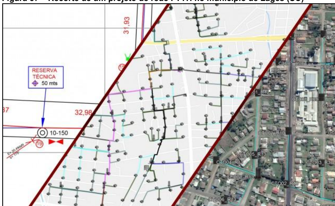
Figura 57 – Recorte de um projeto de rede FTTH no município de Lages (SC)
