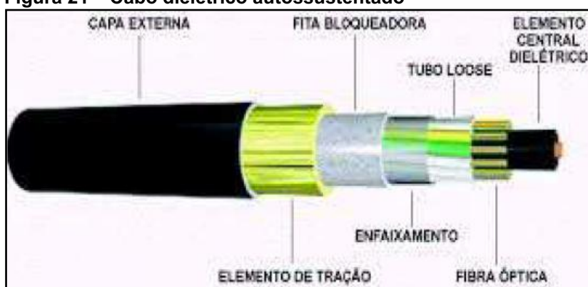
Figura 21 – Cabo dielétrico autossustentado
