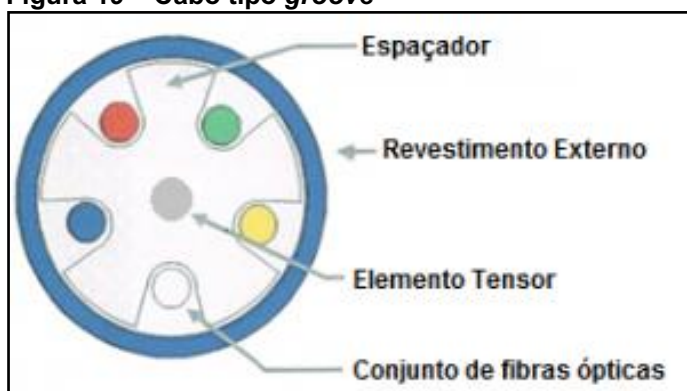
Figura 19 – Cabo tipo groove
