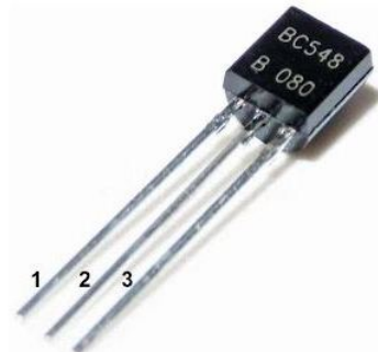
Figura 12 – Dispositivo semicondutor transistor.
