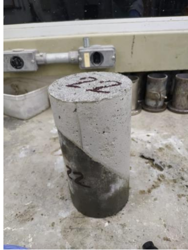
Figura 10 – Corpo de prova composto de concreto e argamassa estrutural que dispensa o uso de pontes de aderência (Arg2-DispensaPA).
