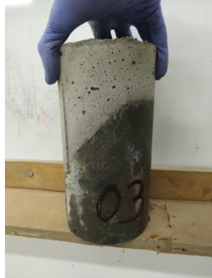
Figura 7 – Corpo de prova composto por substrato de concreto e argamassa de reparo (Arg1-SemPA).
