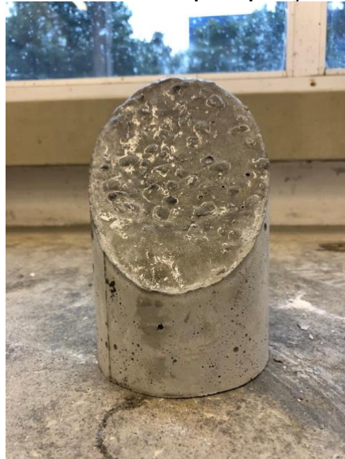
Figura 6 – Base em concreto para aplicação de reparo.
