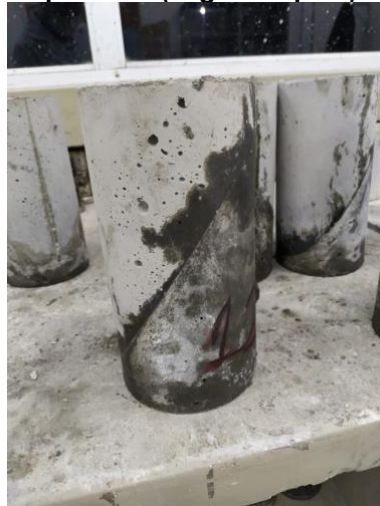
Figura 8 – Corpo de prova composto de concreto, argamassa de reparo estrutural e ponte epoxídica (Arg1-PAEpóxi).
