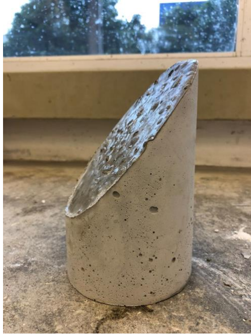
Figura 5 – Base em concreto para aplicação de reparo.
