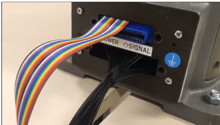
Figura 11 – Novas conexões externas na traseira do Movemaster.
