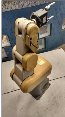
Figura 7 – Movemaster antes do retrofit.
