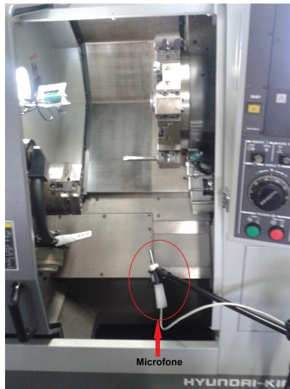
Figura 22 – Posicionamento do microfone na máquina para os experimentos.
