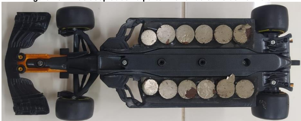
Figura 20 - Ímãs acoplados na parte inferior do carro de Fórmula 1
