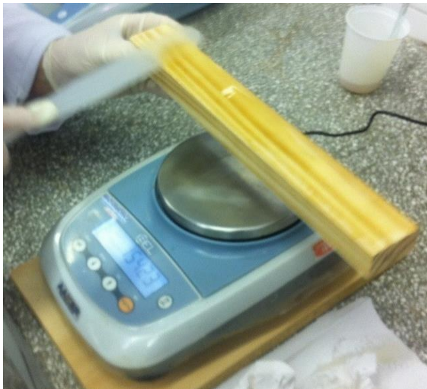
Figura 14 – Aplicação do adesivo PU de mamona de acordo com a gramatura definida com a ajuda da balança de precisão
