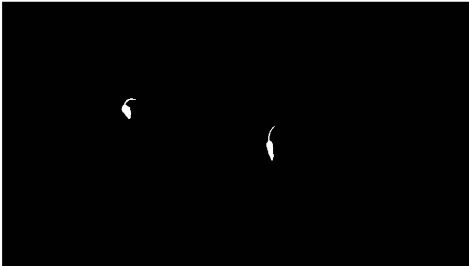
Figura 31 – Máscara da subtração de fundo para o frame exemplo.
