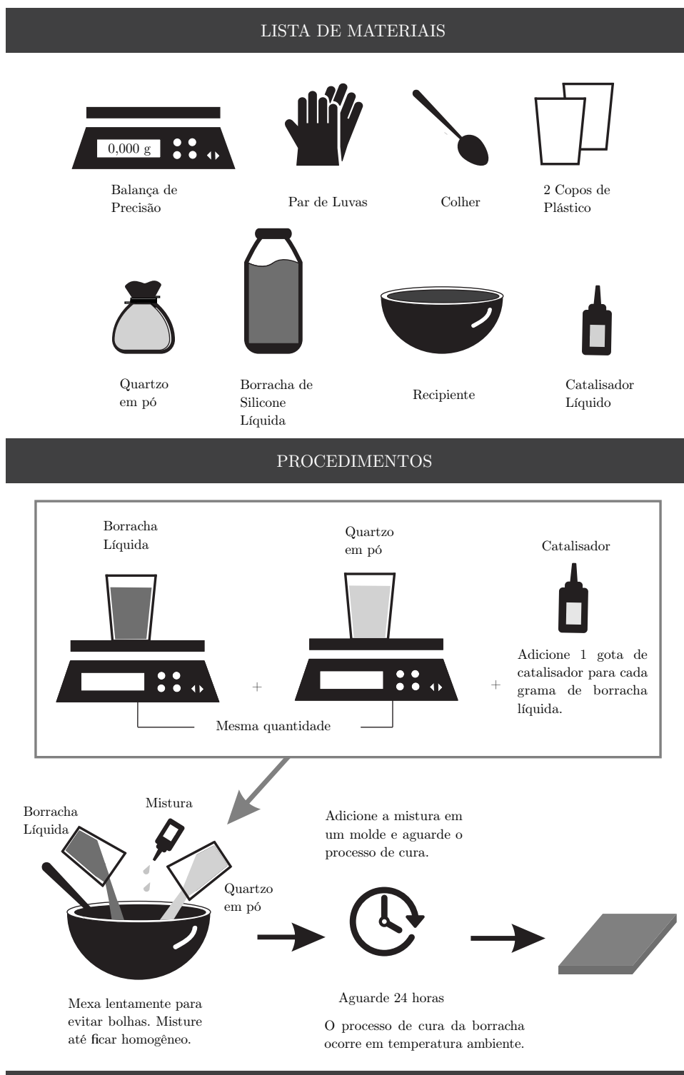
Figura 36 – Materiais e procedimentos para a fabricação da borracha de silicone.
