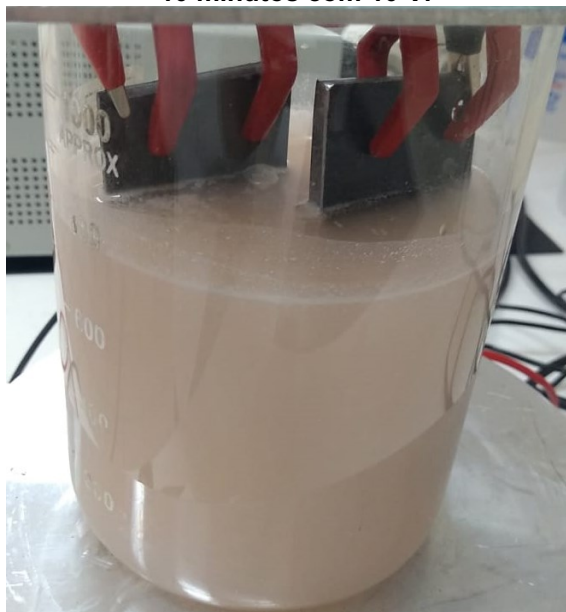
Fotografia 6. Efluente com eletrodos de ferro - 10 minutos com 10 V.
