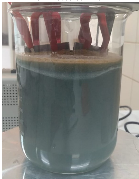
Fotografia 7. Efluente com eletrodos de ferro - 10 minutos com 20 V.
