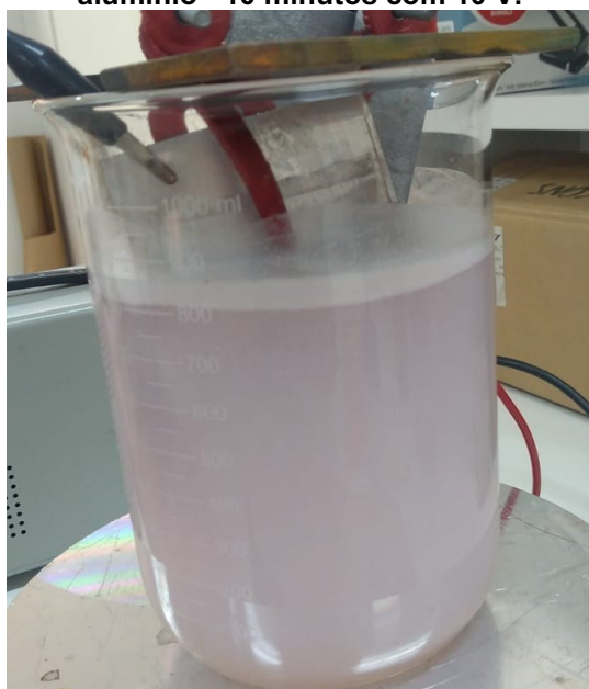
Fotografia 8. Efluente com eletrodos de alumínio - 10 minutos com 10 V.
