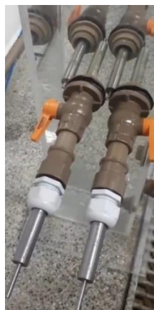
Figura 7 – Detalhe da disposição dos eletrodos de Fe no sistema UASB-EC
