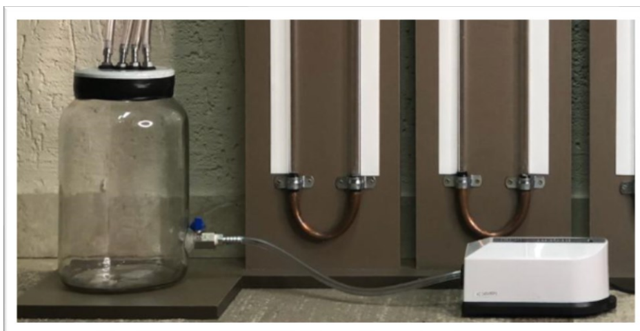
Figura 3: Conexão do compressor ao tubo de vidro pelo registro de esfera
