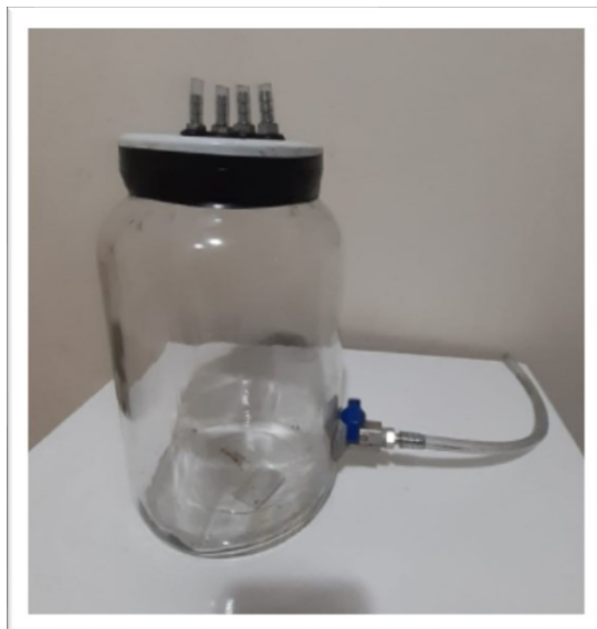
Figura 09: Adaptadores de mangueira fixados na tampa do recipiente de vidro
