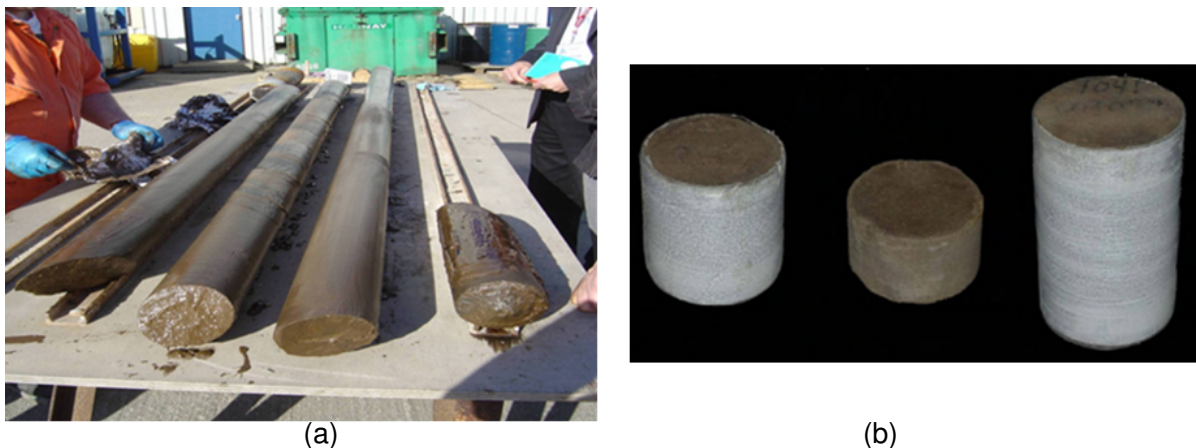
Figura 1.2 – Exemplos de amostras de estruturas rochosas a) recém obtidas e b) limpas e prontas para análises.
