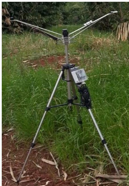
Figura 3 - Microestação meteorológica portátil utilizada para obtenção das variáveis em estudo em sistema silvipastoril.
