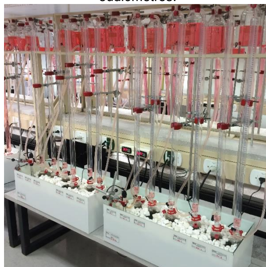
Figura 29 – Digestores já acoplados aos eudiômetros.
