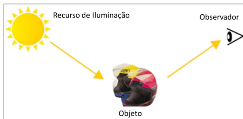
Figura 8 – Elementos para determinação de cor (MAST, 2016)
