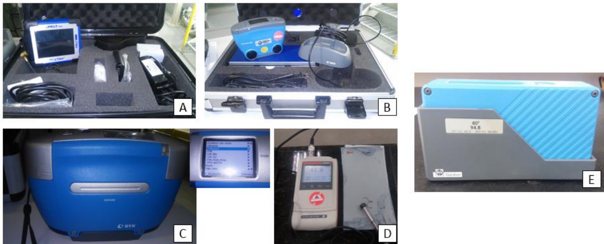
Figura 17 - Equipamentos de medição (A) espessura de camada por filme – \mu\text{Pelt-TS} (B) Wave Scan – Byk (C) Cor – Byk. (D) espessura de camada total – Fischer (E) Brilho 60° – Byk (Autora, 2017).
