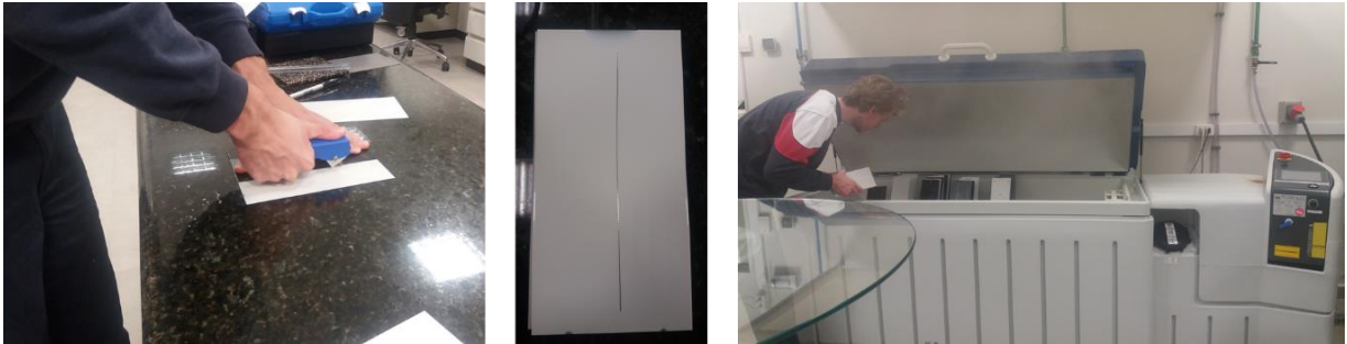
Figura 20 - Corrosão Cíclica – Preparação e início do ensaio (Autora, 2017)
