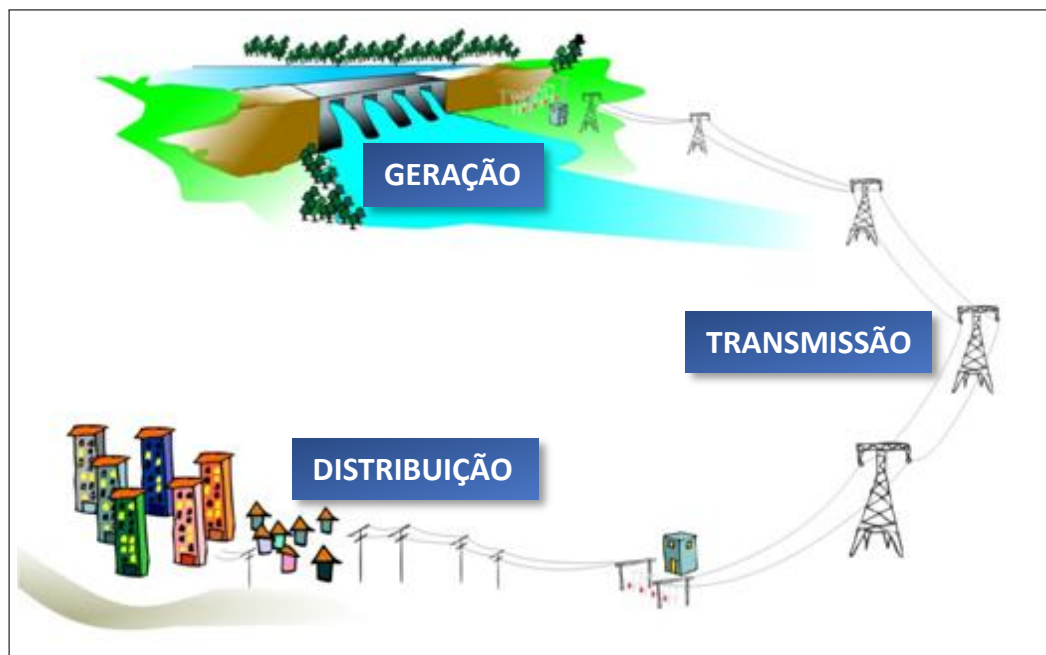
Figura 1 – Segmentos do Sistema Elétrico de Potência
