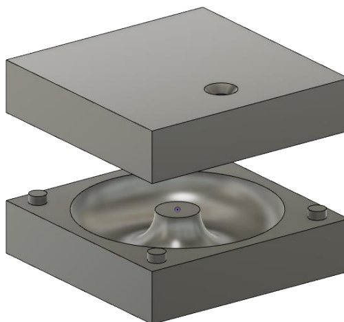
Figura 13 – Vista Geral do Esboço Horizontal do Molde/Protótipo.
