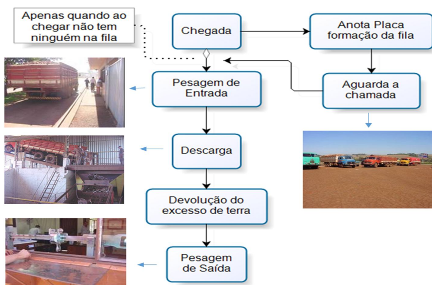
Figura 4 - Fluxograma do processo de recebimento de mandioca em uma Fecularia Fonte: Autoria Própria, (2015).
