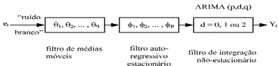
Figura 1. Filtros utilizados para a elaboração de um modelo por meio da metodologia Box-Jenkins. Fonte: Netto, 2015.
