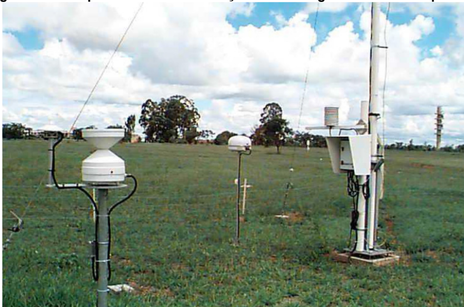
Fotografia 2 - Componentes de uma Estação Meteorológica Automática típica – EMA
