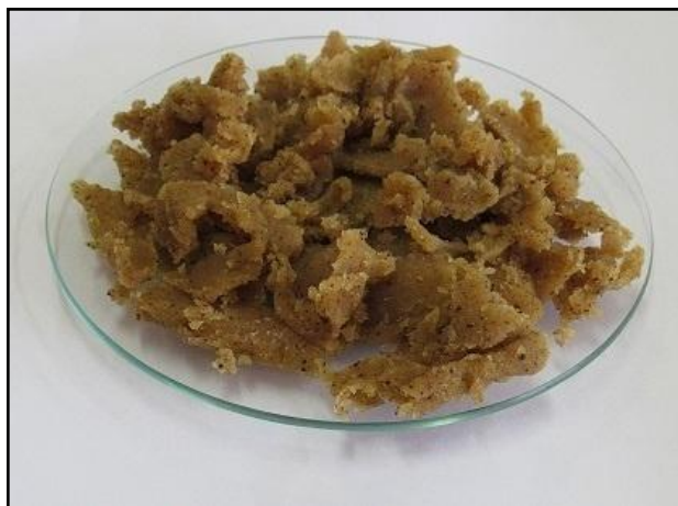
Figura 8: Fibra bruta de mandioca mercerizada em solução alcalina de NaOH 2%.
