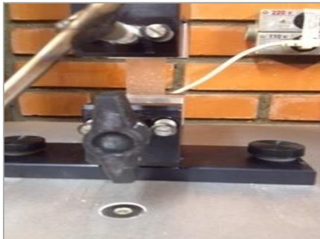
Figura 22: Análise mecânica de tração sendo realizada no nanocompósito.
