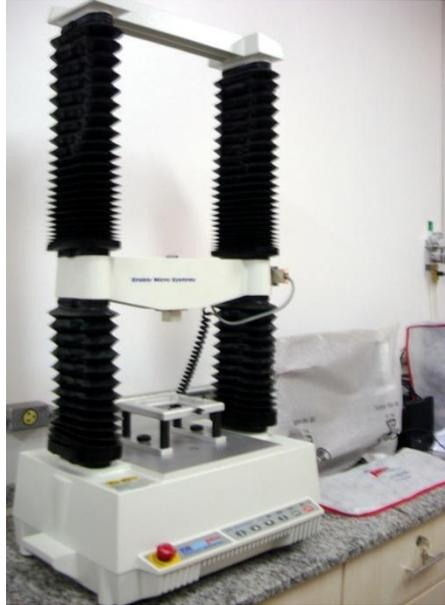
**Figura 12 -Texturômetro utilizado no estudo.**
