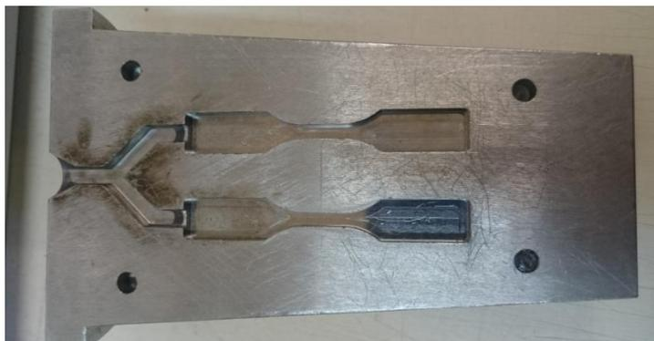
**Figura 10 - Molde utilizado para confecção dos corpos de prova segundo ASTM D-638.**
