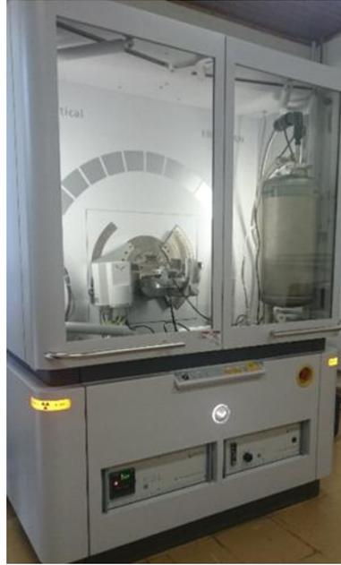
**Figura 11 - Difratorômetro Panalytical, modelo Empyrean (UNILA, 2016);**
