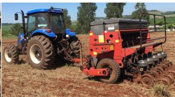
Figura 4 - Semeadora-adubadora mecânica
