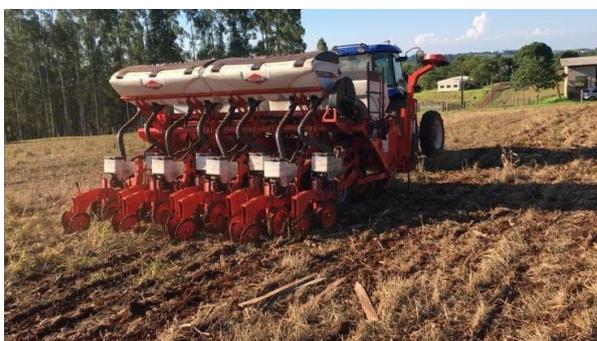
Figura 3 – semeadora-adubadora pneumática
