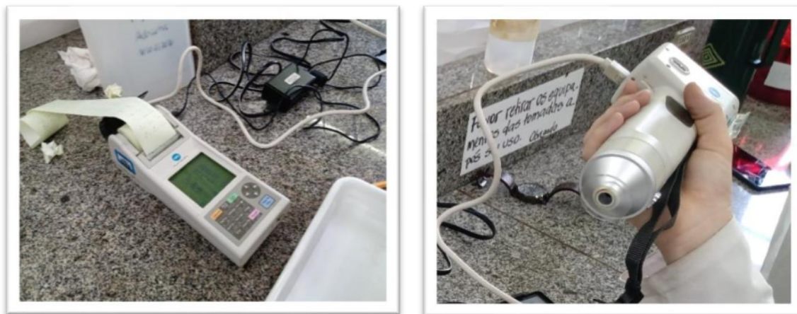
Figuras 6 e 7 – Colorímetro Konica Minolta, modelo CR-400.
