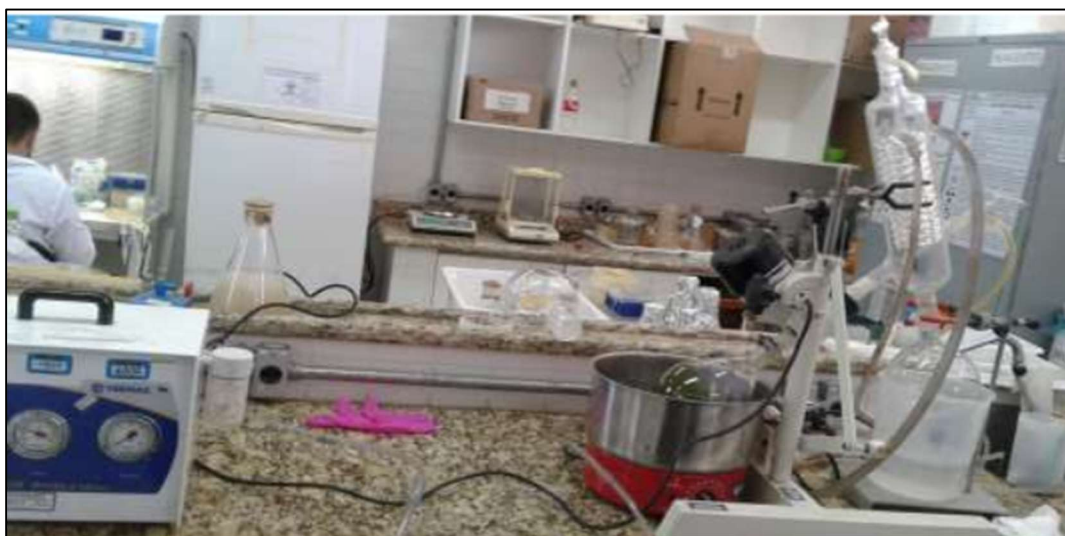
Figura 4. Rota-evaporação dos extratos com solvente etanol 70%.
