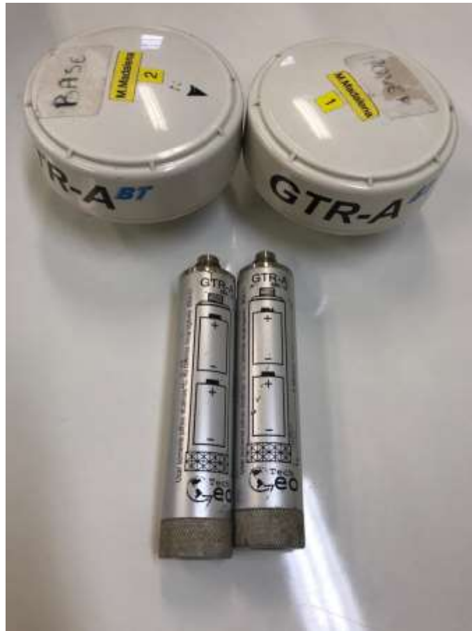
Figura 7: GNSS TechGeo modelo GTR - ABT utilizado no levantamento dos pontos de apoio
