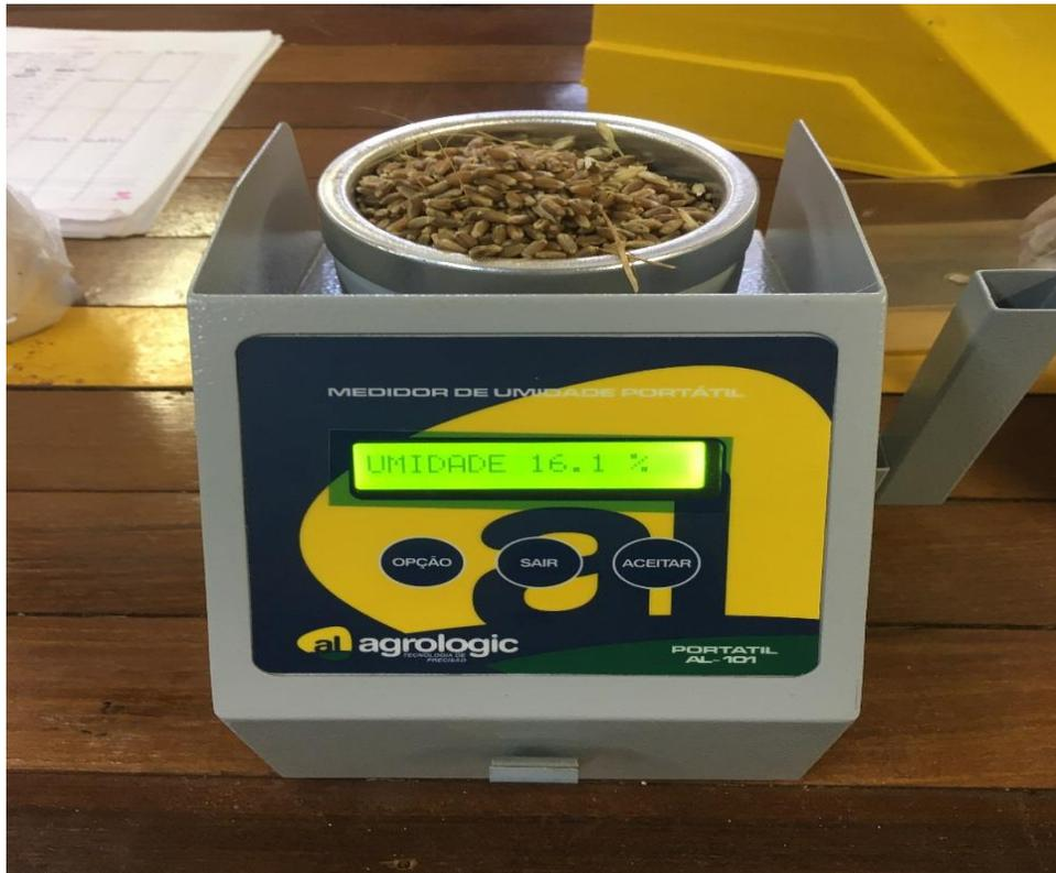
**Imagem 5:** Amostragem para determinação de umidade da semente para colheita.
