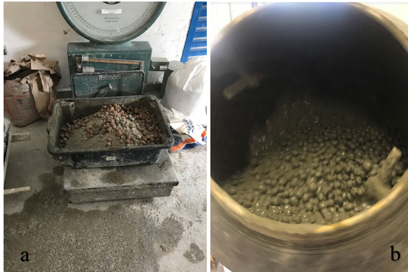
Figura 29 – Confeção de argamassa com argila expandida. a) Pesagem da mistura do agregado e argila expandida b) Aspecto da argamassa contendo argila expandida
