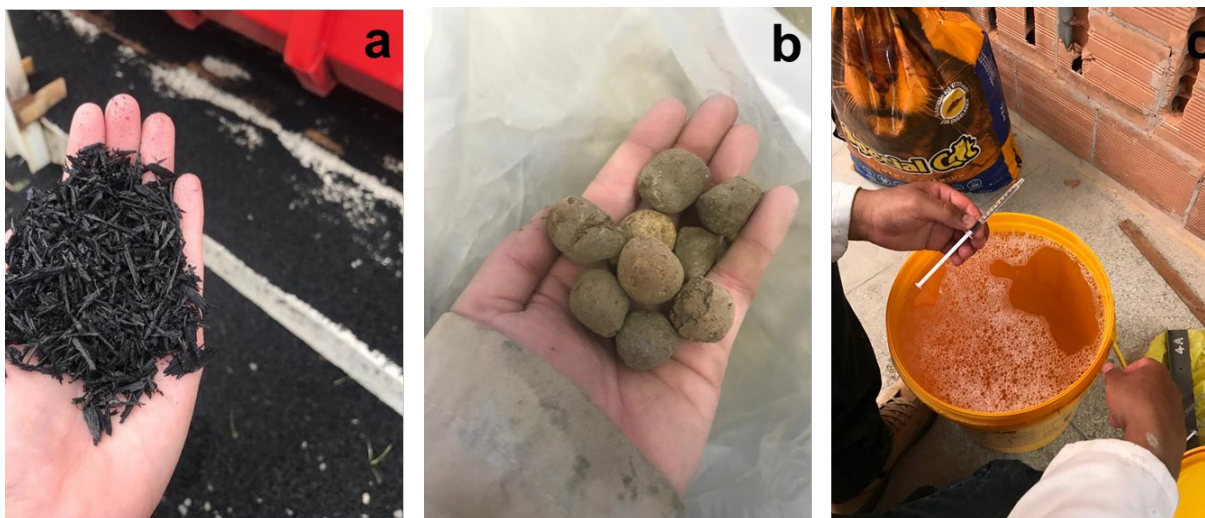
Figura 27 – Materiais adicionados aos sistemas de contrapiso: a) Raspas de borracha; b) Argila expandida e; c) Aditivo incorporador de ar.
