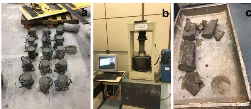
Figura 34 – Ensaio de resistência à compressão das argamassas utilizadas para confecção das placas de contrapiso: a) Corpos de prova recém moldados; b) Realização de ensaio na prensa; c) Corpo de prova rompido ao final do ensaio.
