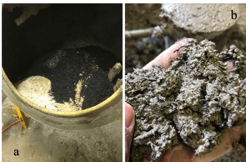
Figura 28 – Confeção de argamassa com raspas de borracha. a) Betoneira com a mistura prévia; b) Aspecto da argamassa contendo raspas de borracha.
