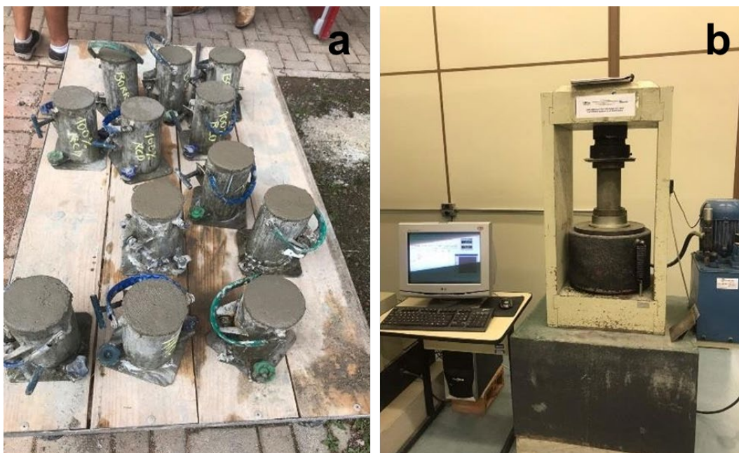
Figura 31- a) Corpos de prova de argamassa moldados para caracterização por resistência mecânica; b) Realização de ensaio de resistência à compressão axial.
