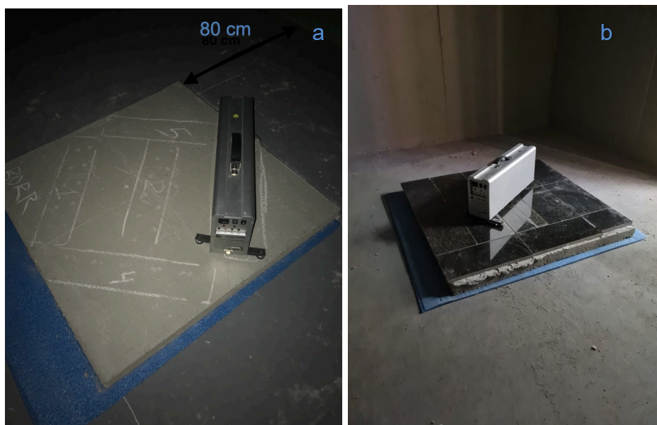
Figura 48 – Posicionamento da placa de contrapiso de materiais alternativos dentro da câmara acústica superior
