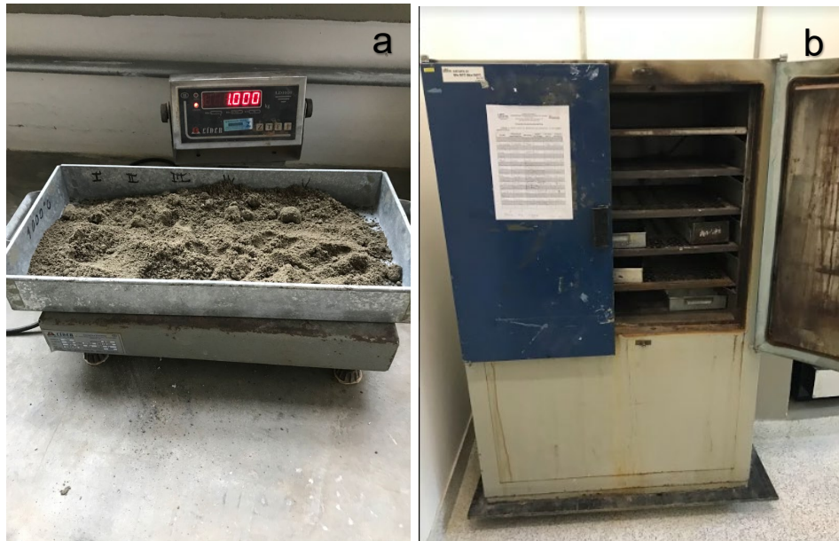
Figura 23 – Ensaio de distribuição granulométrica: a) Pesagem da areia após coleta na usina; b) Secagem da areia de RCD em estufa a (105 \pm 2)^\circ\text{C} .
