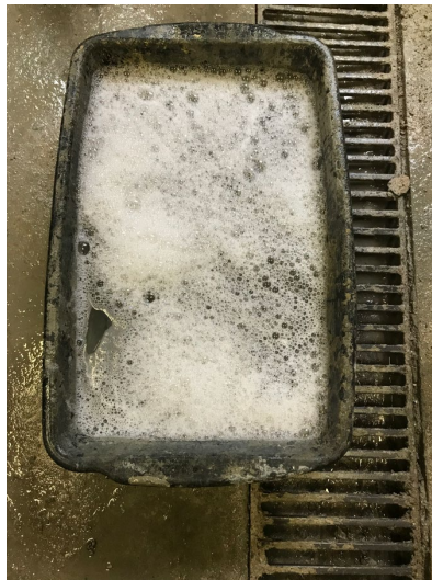
Figura 30 – Confeção de argamassa com aditivo incorporador de ar. Mistura da água com o aditivo.
