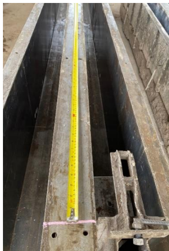
Figura G. 5 – Medição com auxílio da fita métrica
