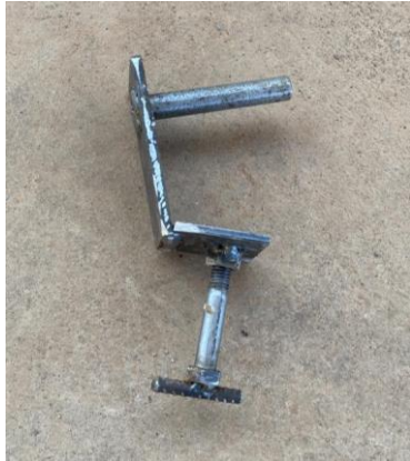
Figura G. 7 – Ferramenta utilizada para substituir os pinos de consolos
