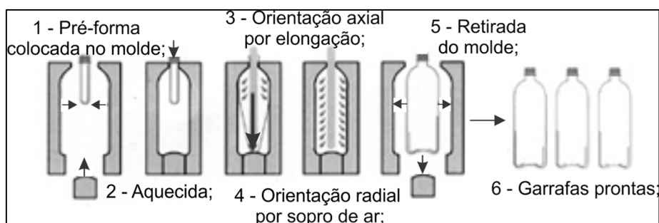
Figura 6 – Parte do processo de moldagem por sopro. Fonte: adaptado de M&G, 2009.
