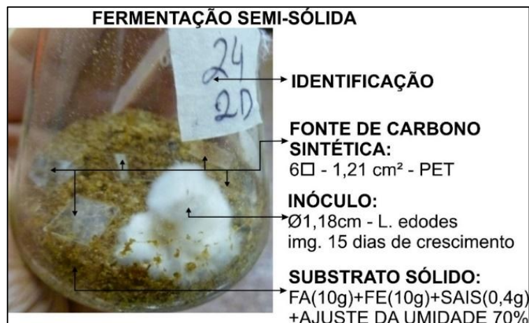
Figura 25 – Exemplo da formulação do ensaio de fermentação semissólida.
