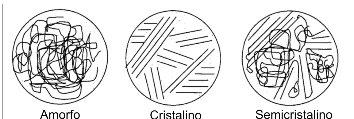
Figura 4 - Esquema ilustrativo das cadeias poliméricas em estado amorfo, cristalino e semicristalino.
