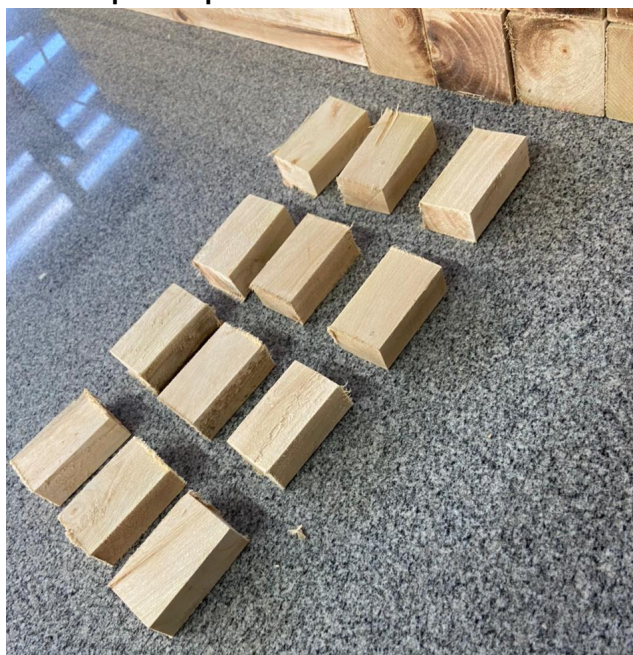
Figura 05 - Corpos de prova ensaio de umidade antes da estufa
