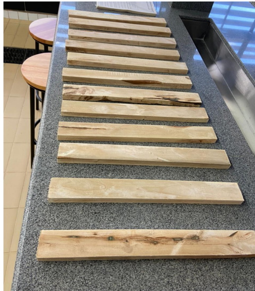
Figura 11 - Corpos de Prova para ensaio de tração paralela às fibras
