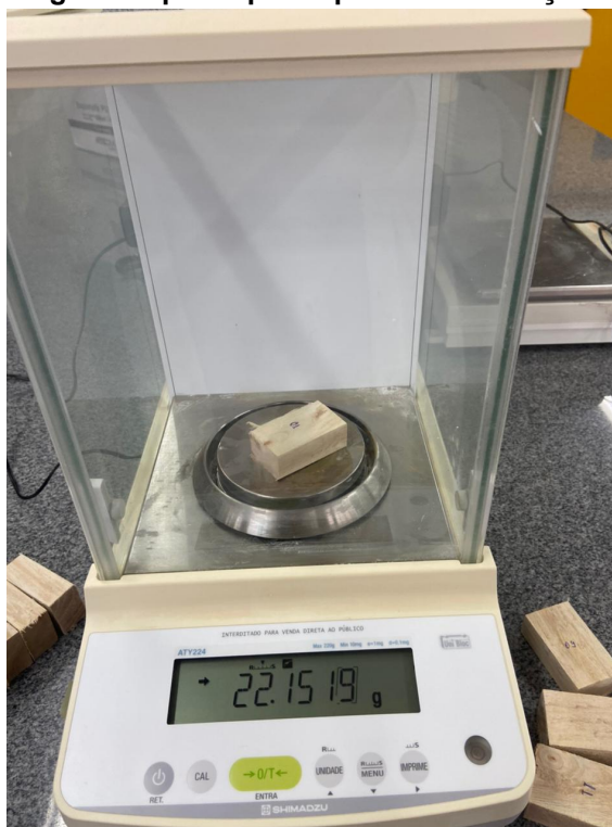
Figura 06 - Pesagem corpo de prova para determinação de massa seca
