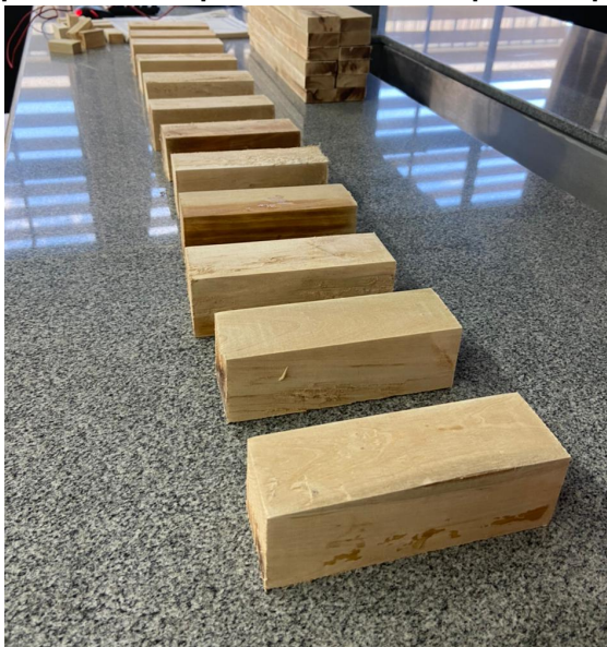
Figura 08 - Corpos de Prova para ensaio de compressão paralela às fibras
