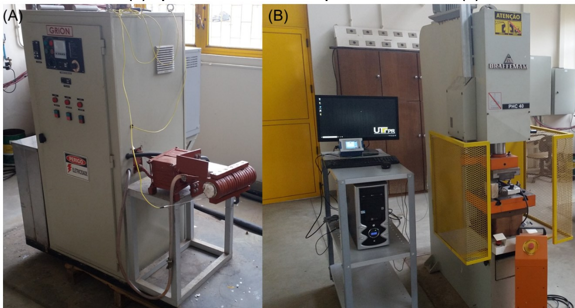
Fotografia 3 - Bobina acoplada ao forno de indução utilizada para globularização das amostras (A) e prensa com sistema de aquecimento da matriz (B)
